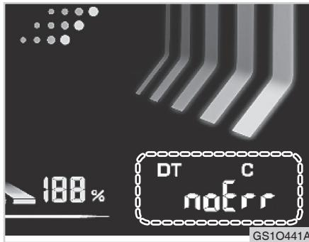
고장 코드 확인은 차량 속도가 "0" km/h 상태에서 핸들부 RESET(리셋) 버튼과 SELECT(셀렉트) 버튼을 2초간 누르면 계기판 우측 하단에 DTC 고장 코드가 생성되며 2초 단위로 고장 코드가 차례로 표시됩니다.
