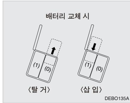
본 차량에는 구동용 배터리가 2개 장착되어 있습니다. 탈착을 위하여 배터리 커버를 개방한 후에는 반드시 배터리 커버를 닫아야 배터리 "ON" 상태가 되어 차량 동작이 가능하게 됩니다.
